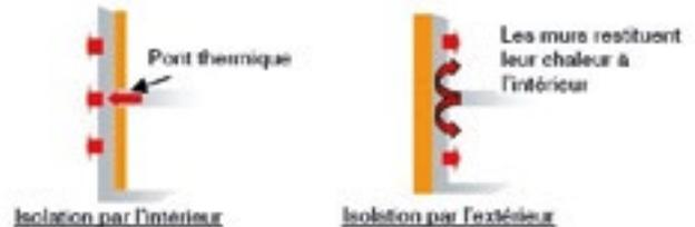
Une isolation par l'extérieur présente également l'avantage de ne pas modifier les surfaces habitables, de gagner en inertie thermique, de protéger les murs des aléas climatiques et donc d'augmenter la durée de vie du bâti.
