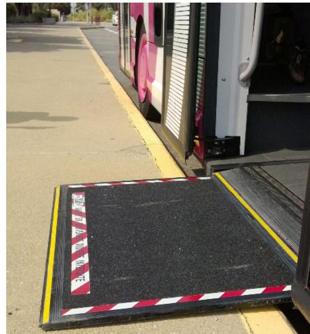
Exemple de rampe d'accès installé sur les véhicules ENVIBUS
