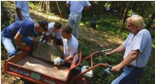
Brouette mécanique pour le transport et le tri des pierres.
