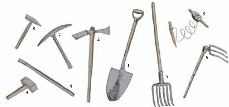
1. Pelle, 2. Pioche-Hache ou « Jean-Pierre », 3. Cordeau, 4. Barre à mine, 5. Fourche de Cantonnier, 6. Croc, 7. Pioche, 8. Têtu pic, 9. Têtu massette
